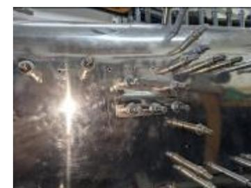
Installation des « fairings » pour la sortie des câbles du gouvernail de direction.
