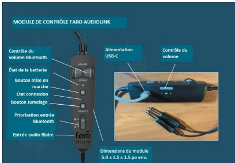
Bluetooth pendant plus d'une seconde et un indicateur d'état bleu confirme qu'il est activé ou en mode de couplage.
