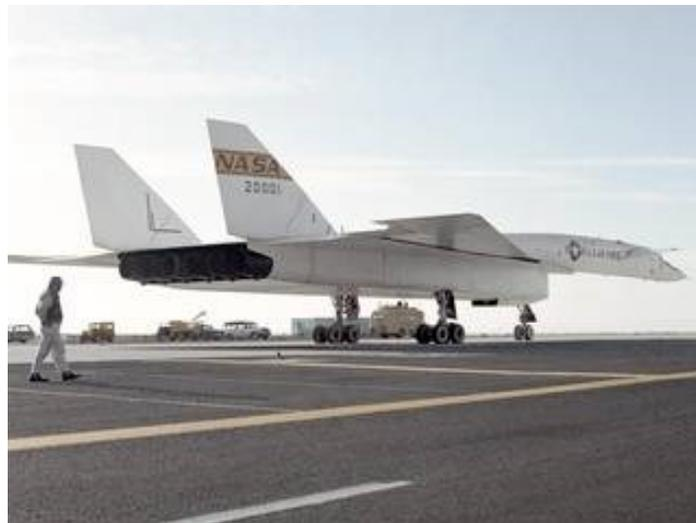
Cette machine était un banc d'essai parfait pour la recherche SST. Elle était de la même taille que les conceptions SST projetées et utilisait des matériaux de structure similaires, tels que le nid d'abeilles en acier inoxydable et le titane. Ainsi, son rôle est passé d'un prototype de bombardier habité à l'un des avions de recherche les plus remarquables jamais pilotés.
